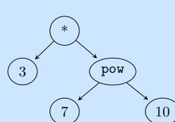
Attention à la priorité des opérateurs, comme la puissance est prioritaire sur la multiplication, l'opération "pow" doit apparaître plus bas dans l'arbre (car elle doit être réalisée en premier).
